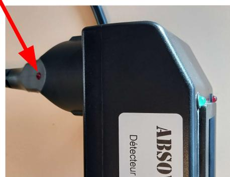
Pour constater si la Terre est défectueuse ou si la Phase est à gauche il suffit de retourner la prise du cordon (repère rouge non apparent).
